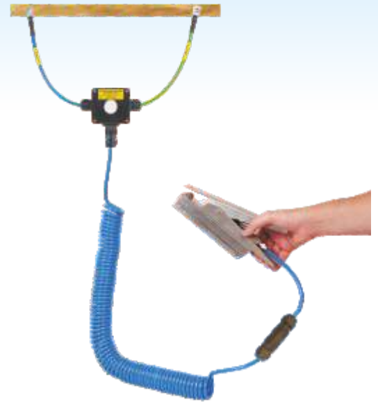
Bond-Rite-Erdungsklammer mit zweiadrigem Kabel, Anschlusskasten, Verstaungszapfen für die Erdungsklammer und Erdungsleitungen. Die Platte zur Überwachung des Stromkreises sowie die Batterie befinden sich im Innern der Erdungsklammer. Die Erdungssammelschiene ist nicht im Lieferumfang enthalten.
