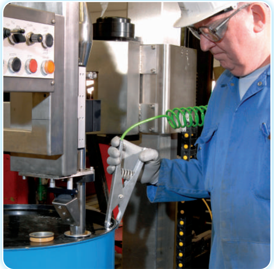
Cen-Stat Klammern sind darauf ausgelegt, Beschichtungen, verhärtete Produktlagerungen, Rost und Schmutz zu durchdringen, um niederohmige elektrische Anschlüsse zu ermöglichen, die statische Elektrizität sicher ableiten.
