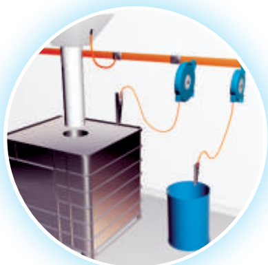
Erdung von Metall-IBC's und Trommeln mit Klammern und selbsteinziehenden Kabelrollen (weitere Details umseitig)
