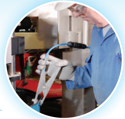
Universal-Erdungsklammer komplett mit Schnellverbinder
