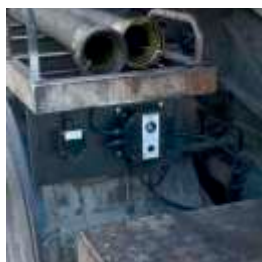
Das Earth-Rite II MGV -Erdungssystem kann an Saugtankwagen und Tanklastzügen angebracht werden.
